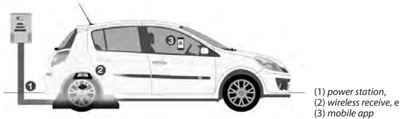
Figura 1 – Mecanismo de funcionamento da Hevo Power:
